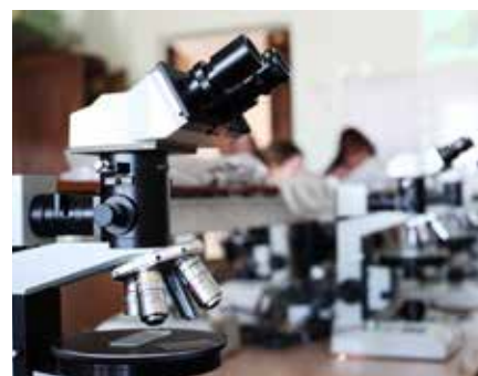
Микроскопы ML9420 с объективами Strain Free SM Planachromat 4x, 10x, 40x, 100x «на бесконечность»
