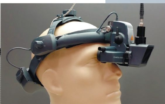
Непрямой офтальмоскоп с интегрированным модулем доставки лазерного излучения
